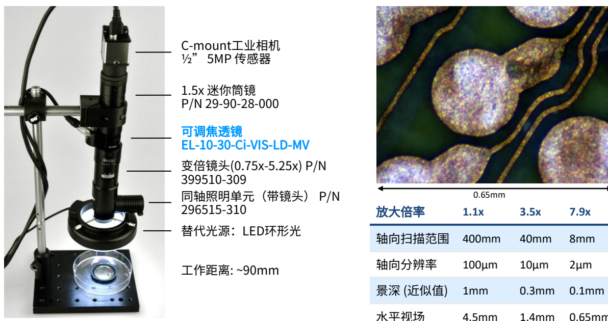
图17：采用标准商用组件构建的高倍率检测系统示例。图中显示一块PCB在7.9 \times 放大倍率下的成像结果（导线宽度为10 \mu\text{m} ）。
