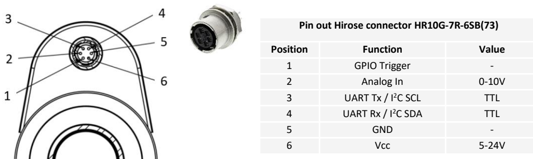
图 7: 带内置 ECC-1C 控制器的镜头型号电气连接示意，使用（母）Hirose 接头。
