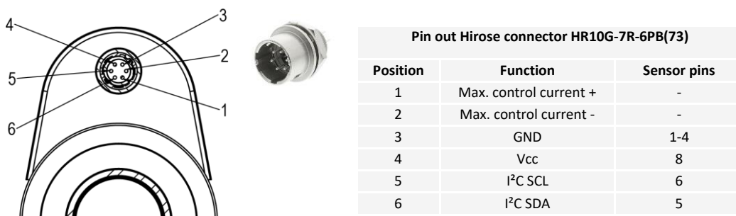
图 6: 不带内置控制器的镜头型号电气连接示意，使用（公）Hirose 接头。
